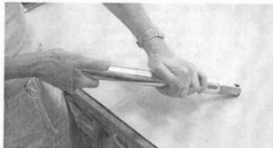
Cleo använder lösa grävthjul som går att byta ut för att skapa olika ystukturer. Ett kraftigt rör gör det lätt att trycka hårt mot plåten.
